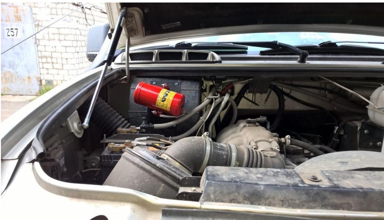
Сгорание и выделение  $\text{CO}_2$  – настолько быстрый процесс, что огонь гаснет в считанные секунды. За это время практически не успевают пострадать ни провода, ни двигатель, ни шланги. Кроме того, при быстром срабатывании системы, после проветривания на автомобиле можно продолжать движение. Ещё одна особенность системы в том, что она может бесперебойно работать даже при переворачивании автомобиля.
